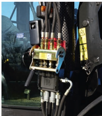
Multikuppler ‚Quickvos‘: Das neue Verbindungssystem aus Meinerzhagen soll das Monopol eines italienischen Anbieters brechen.
